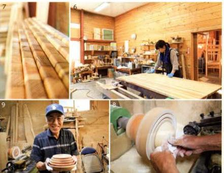
6&7:規格材を木目がなめに走るように接着剤で圧着し、カット。木製品によって矢羽の幅を3cm~40cmに調整。プレス機に1枚づつ積み重ね、さらに板状に切り断して完成と、時間をかけて丁寧な仕事が展開されている。杉矢羽集成材の制作・加工工場
